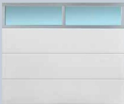
Para todos los modelos de puerta y puertas peatonales laterales con diseño acanalado. Marco de acristalamiento de aluminio anodizado (DIN 17611), superficie en color natural E6/C0 (antes E6/EV1), bajo consulta en el color de la puerta. Disponibles como perfil normal (NF) o perfil con rotura térmica (WF). Acristalamientos sencillos o dobles de material sintético, transparente o translúcido y rejilla deploye.
