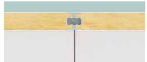
Profundidad de obra 55mm, enrasada
